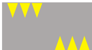
Z 6b Stavebný spomaľovací prah (označenie)
