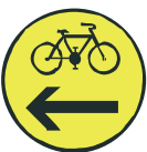
S 7e Signál pre cyklistov so žltým svetlom pre jeden smer so znamením „Pozor!“ (vzor)
