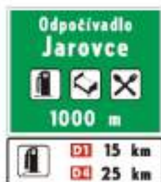
II 18a Odpočívadlo s objektmi služieb (vzor)
